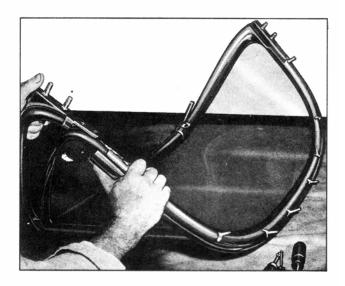
Fig. 4—Removing Side Frame
